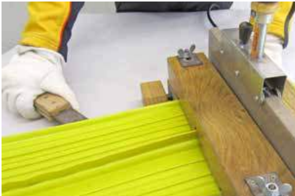
Soudage bout à bout avec gabarit de soudage
