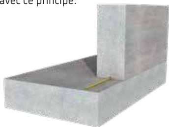
Bande gonflante selon le principe de pression
